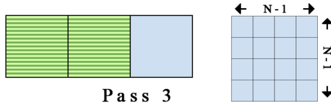
Slika 4.9: Konfiguracija dijeljene memorije u fazi 3 ( Izvor: [12] )
