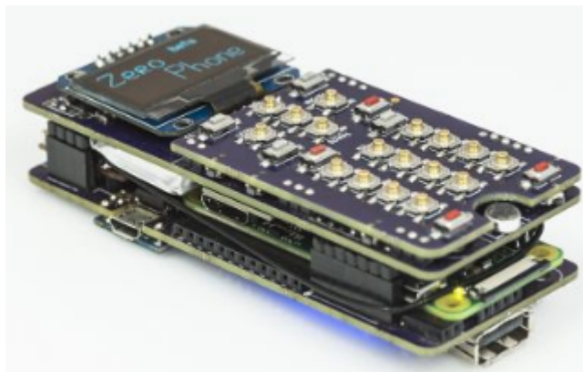
Slika 2.1: Pametni telfon kojeg pokreće Raspberry Pi
