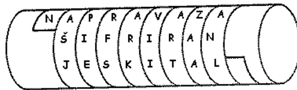
Slika 3.1: Naprava za šifriranje skital
