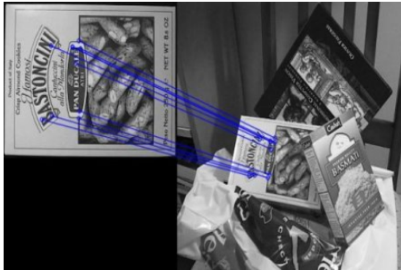
Slika 6: Primjer rezultata funkcije cv2.drawMatches() za prvih 10 matcheva [13]
