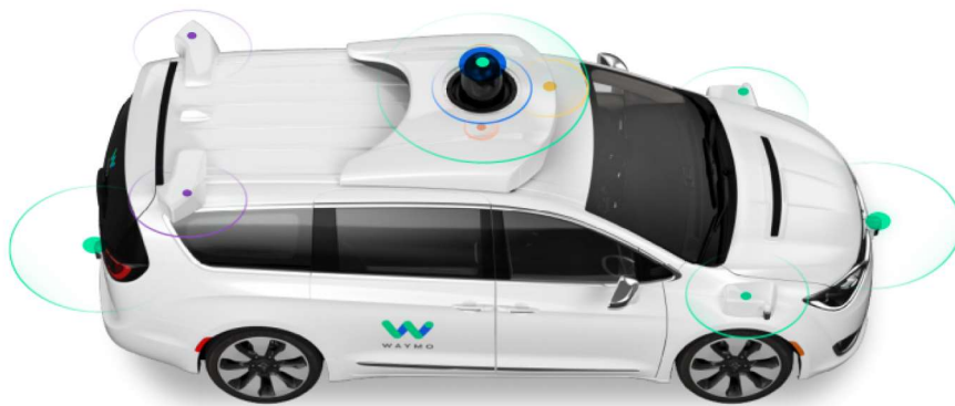
Slika 27: Waymo Driver senzori [18].
