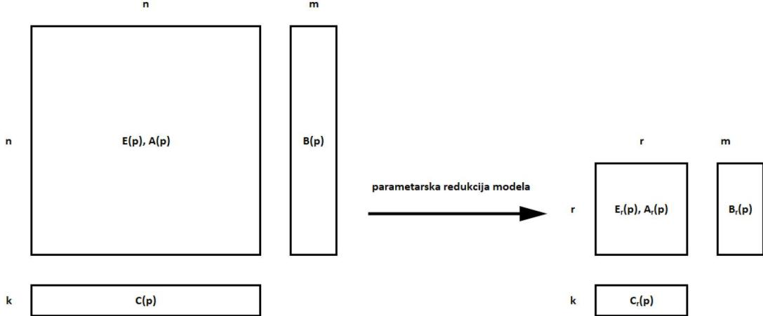
Slika 1: Redukcija reda parametarskog modela u parametru p
