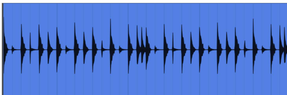
Slika 12: Kompresiran signal sa sporim release parametrom
