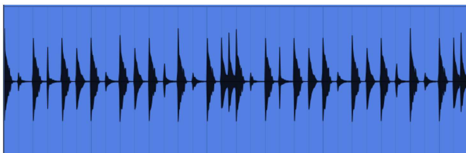
Slika 13: Kompresiran signal sa brzim attack i release parametrima
