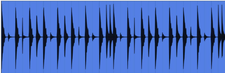
Slika 11: Kompresiran signal sa sporim attack parametrom
