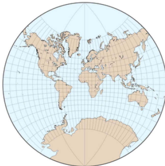
Slika 11: Primjena konformnog preslikavanja u kartografiji (vidi [5])
