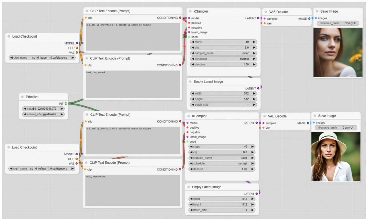
Slika 18: Workflow baznog i refiner modela
