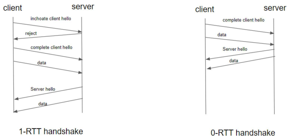
Slika 2: Dijagram prikazuje razliku između 1-RTT i 0-RTT QUIC protokola za uspostavu veze između poslužitelja i korisnika
