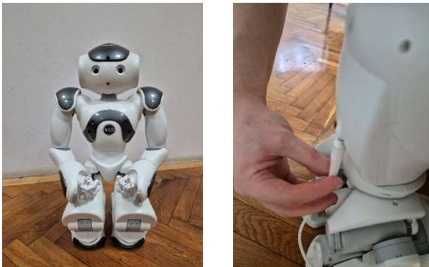
Slika 1 i 2: Spajanje robota na punjač
