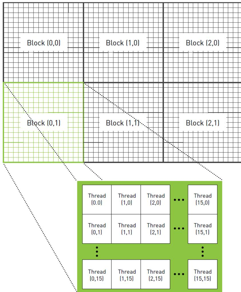
Slika 4.3: Dvodimenzionalna mreža sa dvodimenzionalnim blokovima (*Izvor: [21]*)
