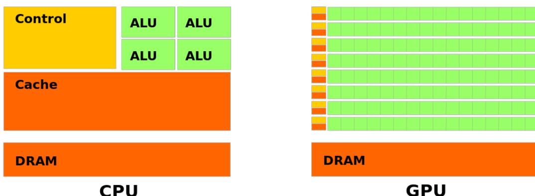
Slika 4.2: Usporedba CPU i GPU arhitekture (Izvor: Wikipedia<sup>12</sup>)
