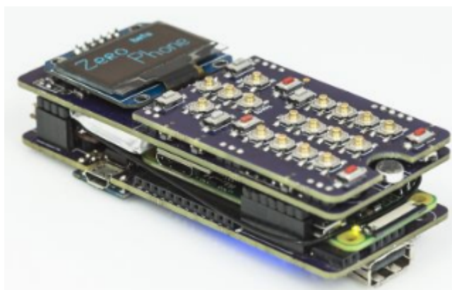
Slika 2.1: Pаметni telfon kojeg pokreće Raspberry Pi
