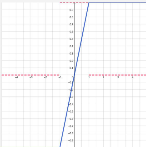
Slika 1.4: Hardtanh funkcija i derivacija
