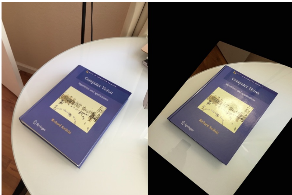
Slika 9: Uz pomoć homografije, transformirali smo desnu sliku [16]
