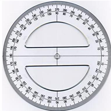
Slika 15: Kružni kutomjer
