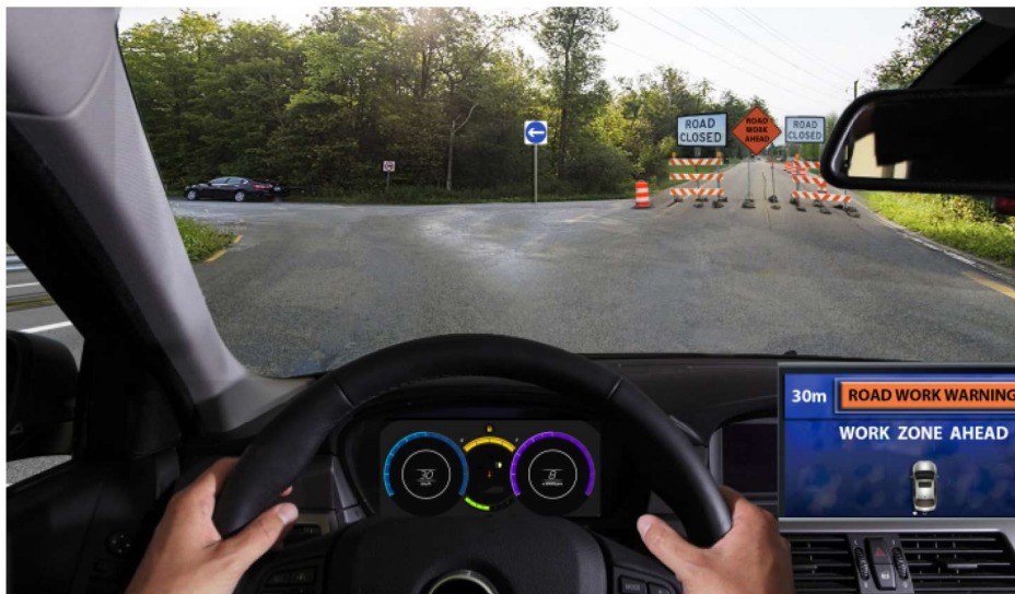
Slika 23: Primjer upozorenja o radovima na cesti [14].
