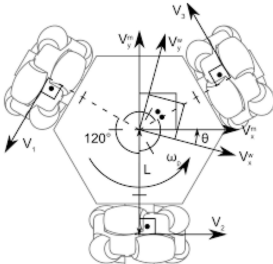
Slika 15 : Pozicioniranje kotača
