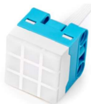
Slika 5: SPIKE Essential matrica sa svjetlima (slika preuzeta iz [13]).
