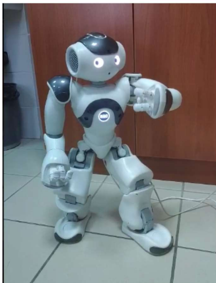
Slika 2: NAO humanoidni robot
