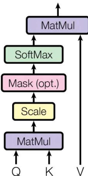
Slika 2: Prikz skalarogn unutarnjeg produkta. Slika preuzeta s [1, p. 4]
