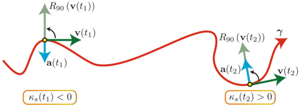
Slika 3.1: Predznak zakrivljenosti krivulje u odnosu na smjer zakretanja, slika preuzeta iz [3]
