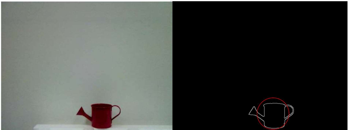
Slika 54: MSE = 180.06 (FALSE za threshold = 50)
