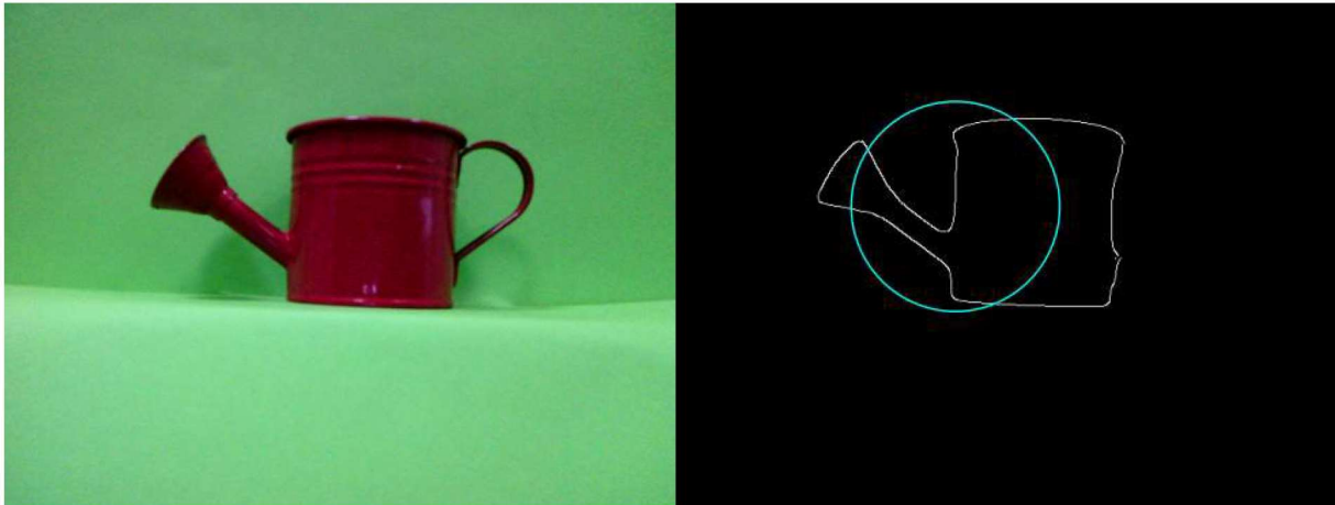
Slika 40: MSE = 2078.33 (FALSE za threshold = 50)
