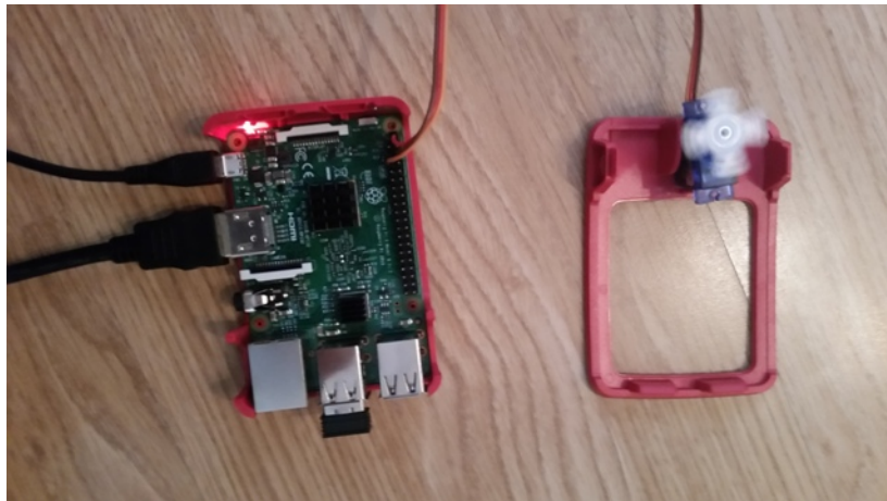
Slika 2.11: Upravljanje servo motorom
