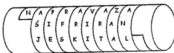
Slika 3.1: Naprava za šifriranje skital
