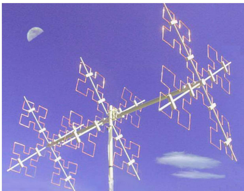
Slika 7.11: Primjena fraktala u dizajnu antena
