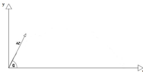
Slika 7: Ispaljivanje projektila s početnom brzinom V_0 u ravnini xy
