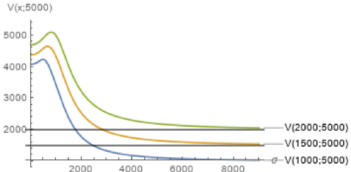
Slika 8: Funkcija  $V$  u ovisnosti o volatilnosti
