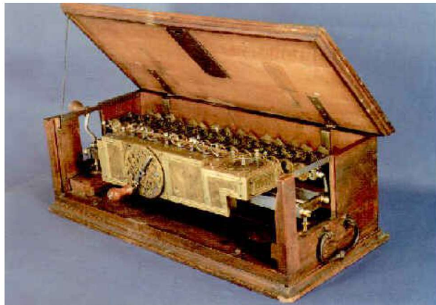
Slika 3: Leibnizov stroj (Izvor: https://bit.ly/3CiAO1r )
