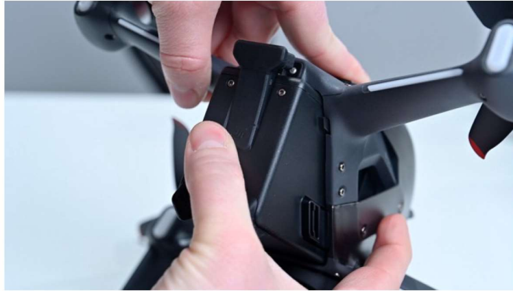
Slika 6 : Promjena baterija na dronu
