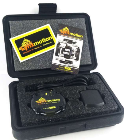
Slika 5 : Mikrokontroler Quadrino Nano
