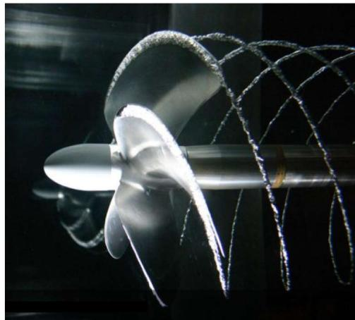
Slika 11: Propeler plovila zapravo je dio helikoidalne plohe generirane sa više generatriza čiji je nagib jednak te svaka od njih ima jednu zajedničku točku s osi rotacije. Slika je preuzeta iz [6].
