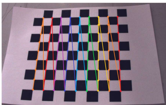
(c) Krivi poredak vrhova. Za ispravak se koristila kombinacija rotiranja i reversanja vektora vrhova.
