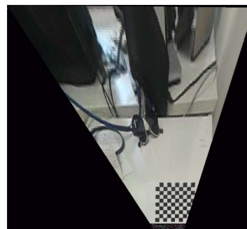
(e) Ptičja perspektiva slike s gridom razmaka lokacija 0.2. Ovdje više nema praznih piksela
