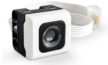
Slika 6: SPIKE Essential senzor za raspoznavanje boja (slika preuzeta iz [12]).
