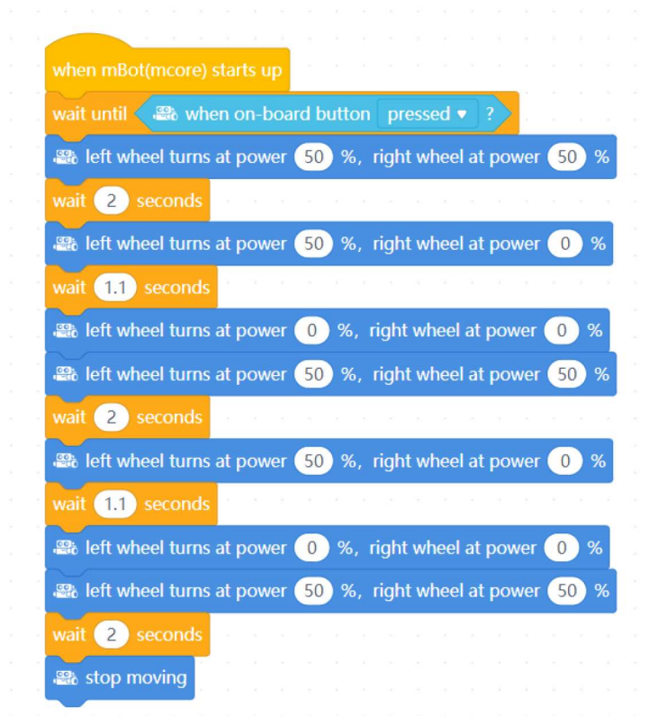
Slika 6: program za mBot: Kretanje mBota po stranicama zamišljenog jednakostraničnog trokuta
