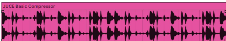
Slika 27: Signal kompresiran JUCE kompresorom
