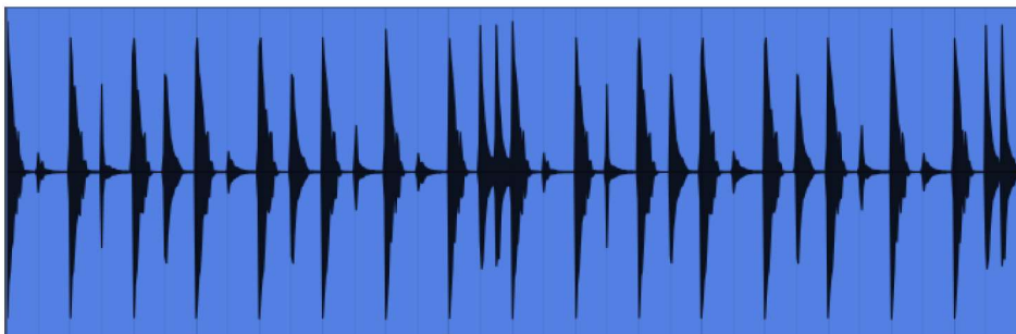
Slika 11: Kompresiran signal sa sporim attack parametrom
