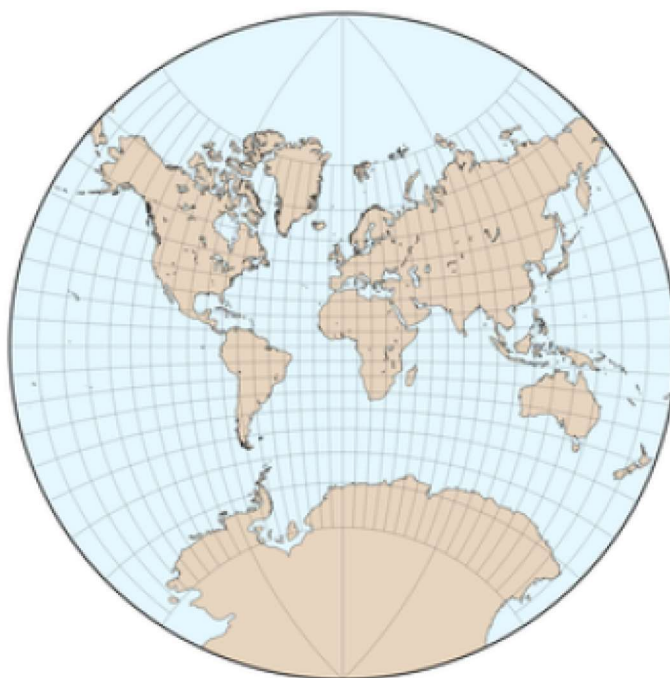
Slika 11: Primjena konformnog preslikavanja u kartografiji (vidi [5])
