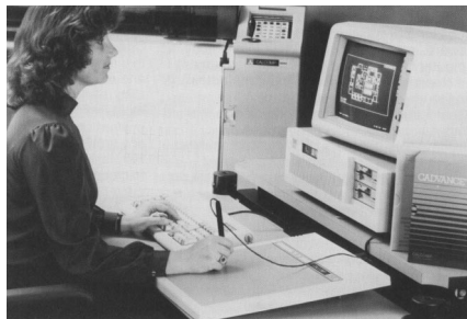
Slika 2.1: Uređaj GRAFACON (RAND TABLET), preuzeto s [25]
