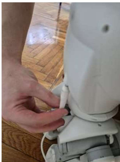
Slika 2.2: Spajanje robota na punjač
