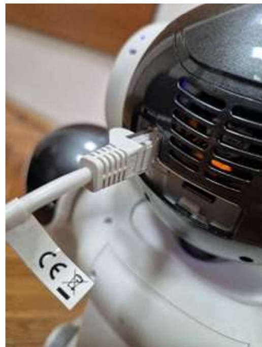
Slika 2.4: Spajanje robota na računalo
